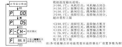
出厂功能设置:模拟测试时,默认支持超温跳闸功能触点启动;若模拟测试时,要求超温跳闸功能触点不予启动,可根据点3.6进行操作设置。
